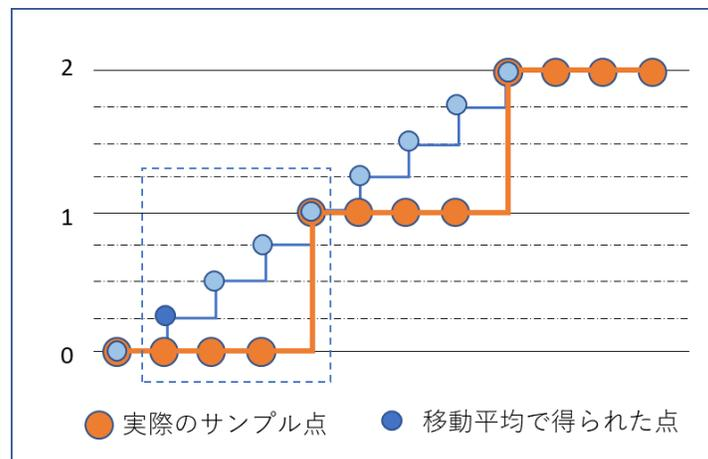
図 2: 4 点の移動平均による分解能の向上
