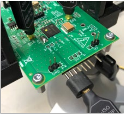
DL-ISOでVgs(MMCX接続)およびVds(ヘッドピン接続)信号を測定
